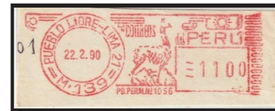
Franqueo Mecánico Pitney Bowes 5300., Las medidas de la impresión son 57 mm. x 22 mm. "P.B. PERM. No." corresponde como prefijo del número asignado a la máquina por el fabricante
